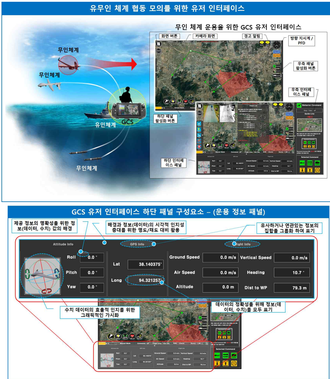
그림 3. AI 기반 시뮬레이터 User Interface 구조
