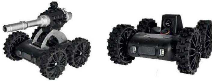
그림 5. Nexter Robotics 사에서 개발한 Nerva LG 지상 초소형 로봇
