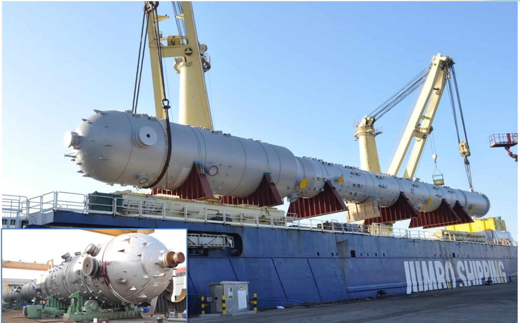
[스테인리스 재질, 총 중량 752Ton 쿠웨이트 디-메타나이저 타워]
