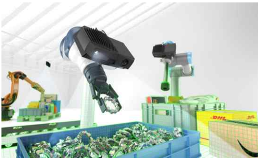
<로봇용 3D 비전을 이용한 사물인식 및 피킹포인트 생성>
